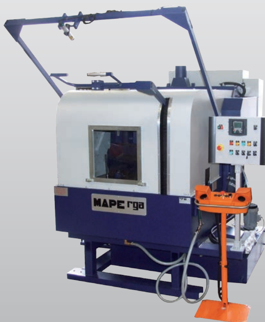
COMMODORE 500 SPÉCIALE TRONÇONNEUSE À MEULE Ø 500 SOUS ARROSAGE
